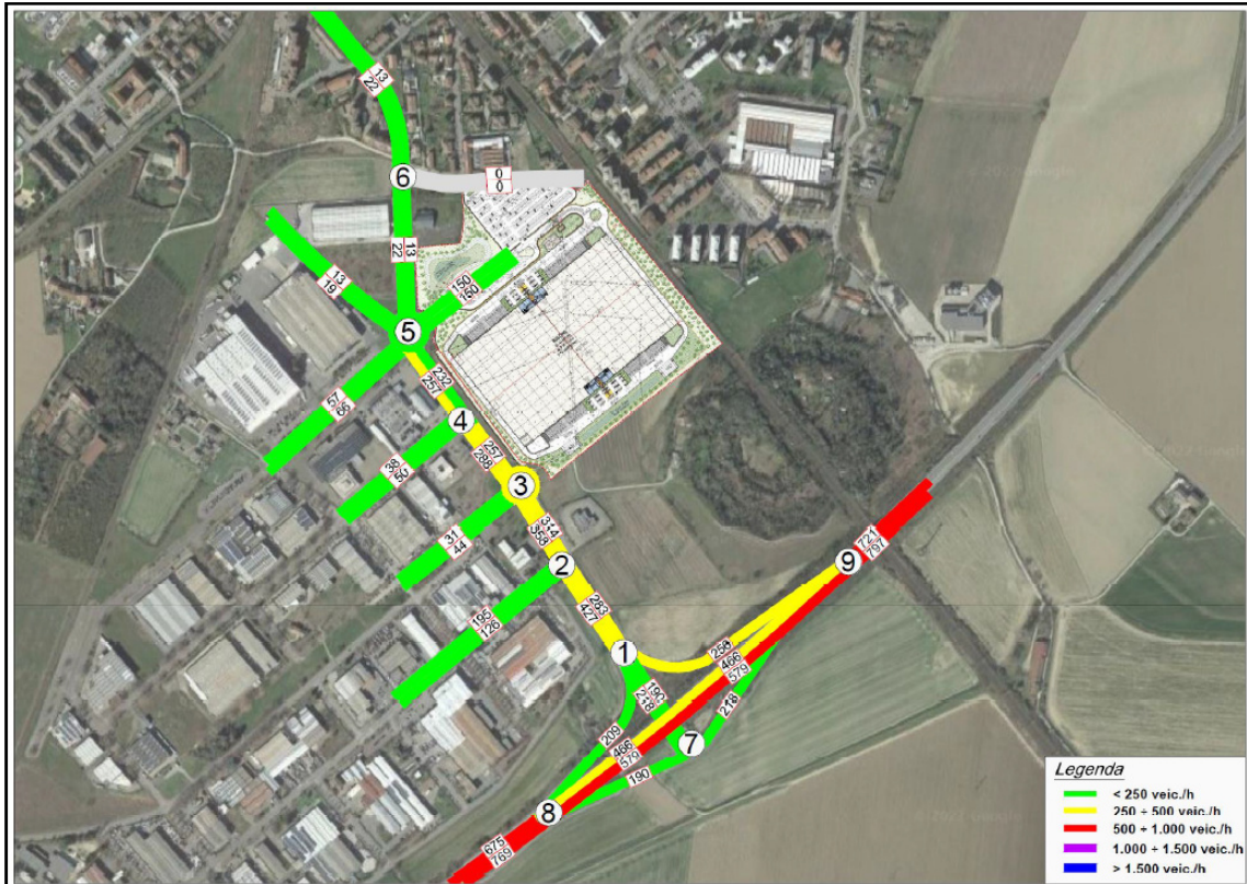
Diagramma di carico rete scenario progetto – veicoli pesanti – TGM diurno 6.00-22.20
