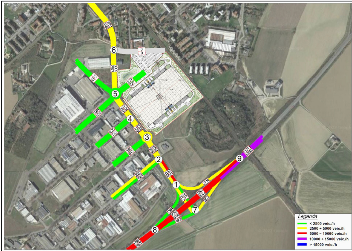
Diagramma di carico rete scenario progetto – veicoli leggeri – TGM diurno 6.00-22.20
