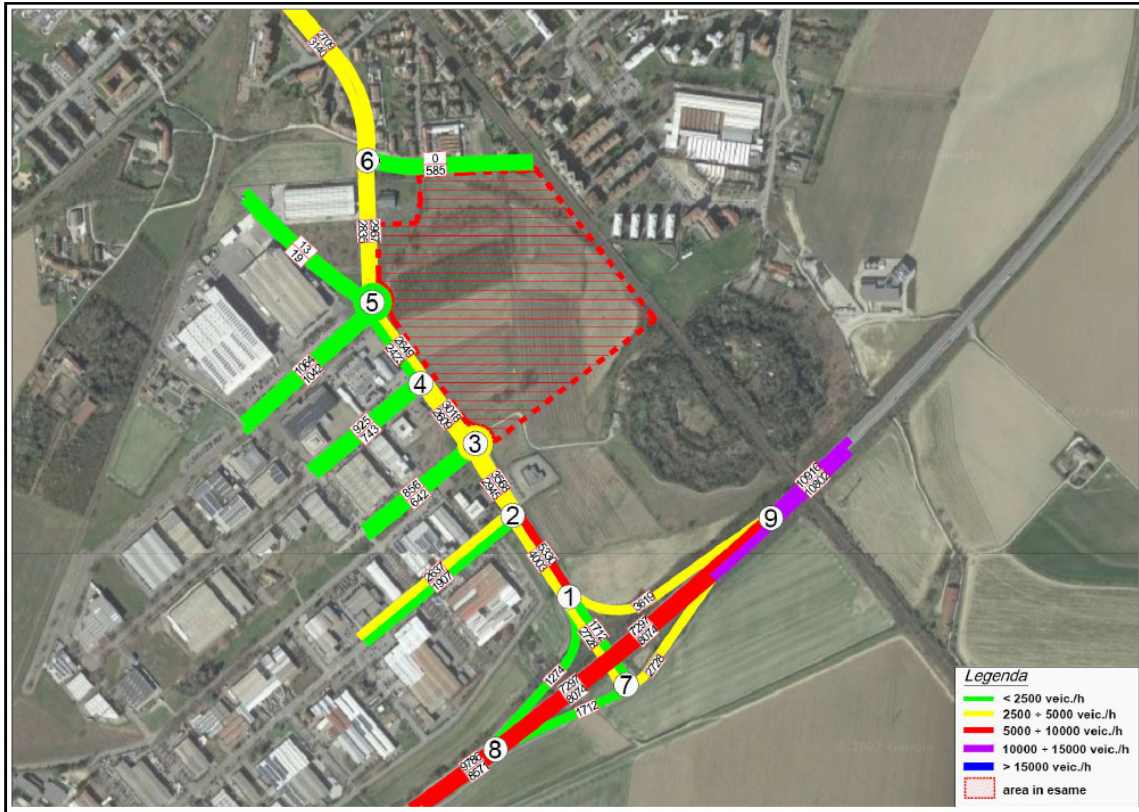
Diagramma di carico rete scenario attuale – veicoli leggeri – TGM diurno 6.00-22.20
