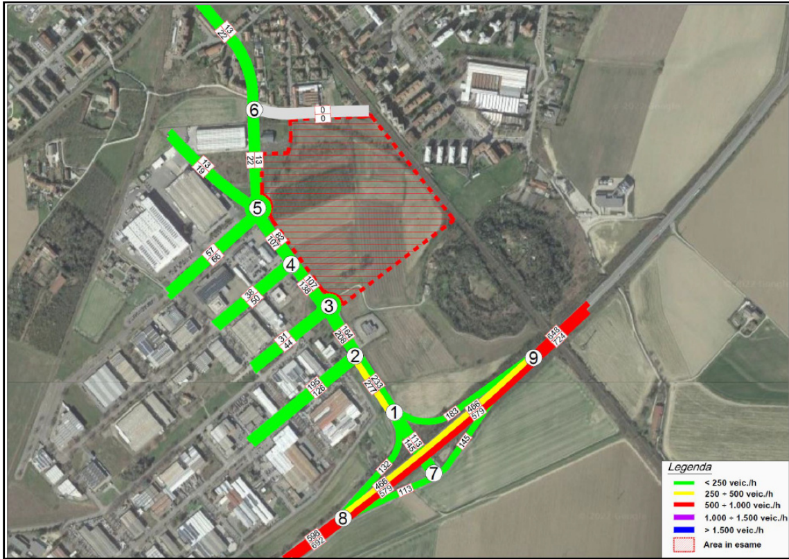
Diagramma di carico rete scenario attuale – veicoli pesanti – TGM diurno 6.00-22.20
