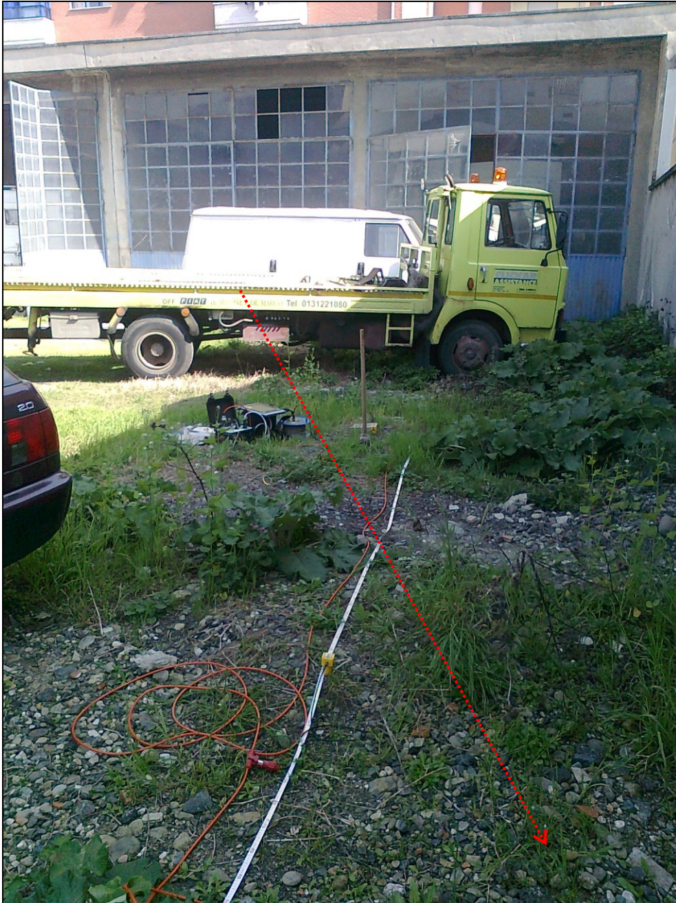
Stendimento sismico MASW (mazza battente)
