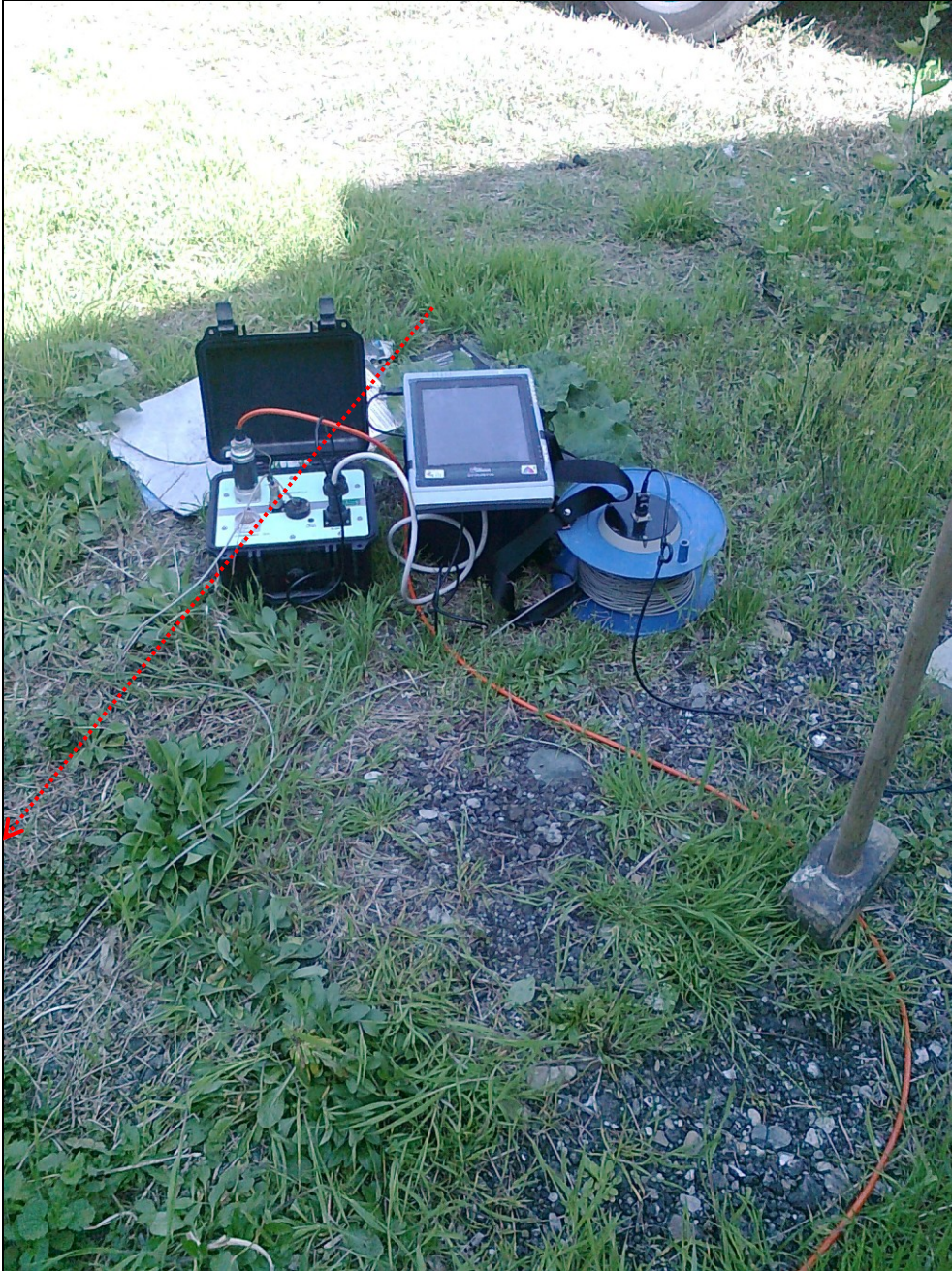
Stendimento sismico MASW (SIMOGRAFO PASI)
