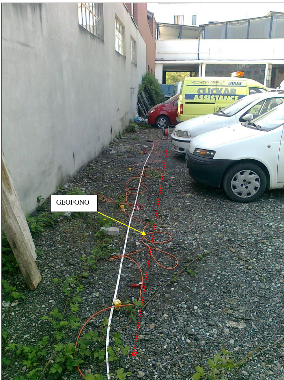
Stendimento sismico MASW (geofoni infissi nel terreno)
