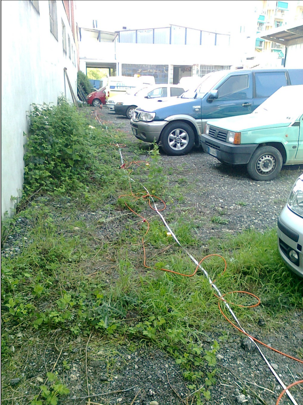
Stendimento sismico MASW
