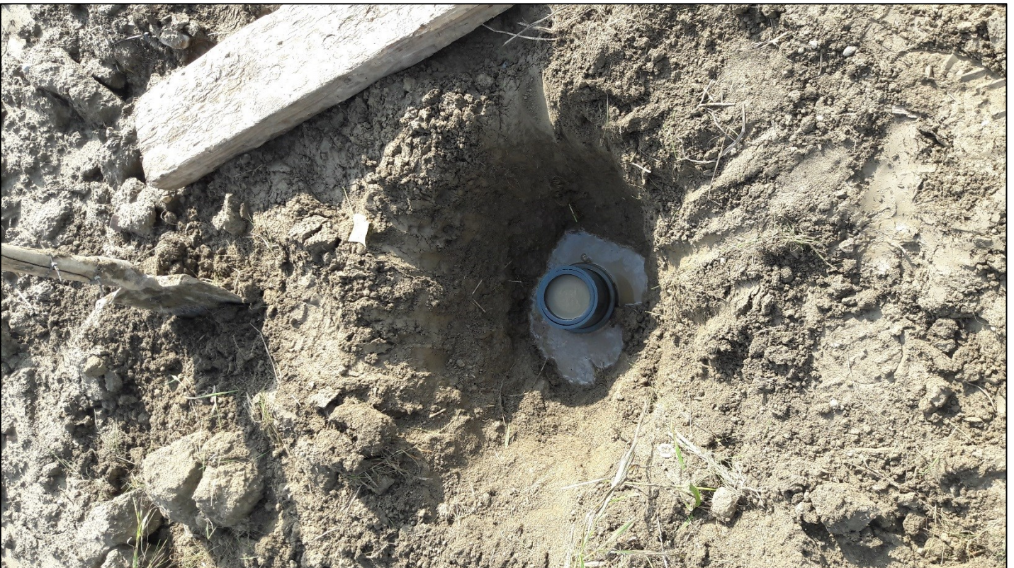
Prova di permeabilità mediante permeametro a carico variabile in pozzetto superficiale
