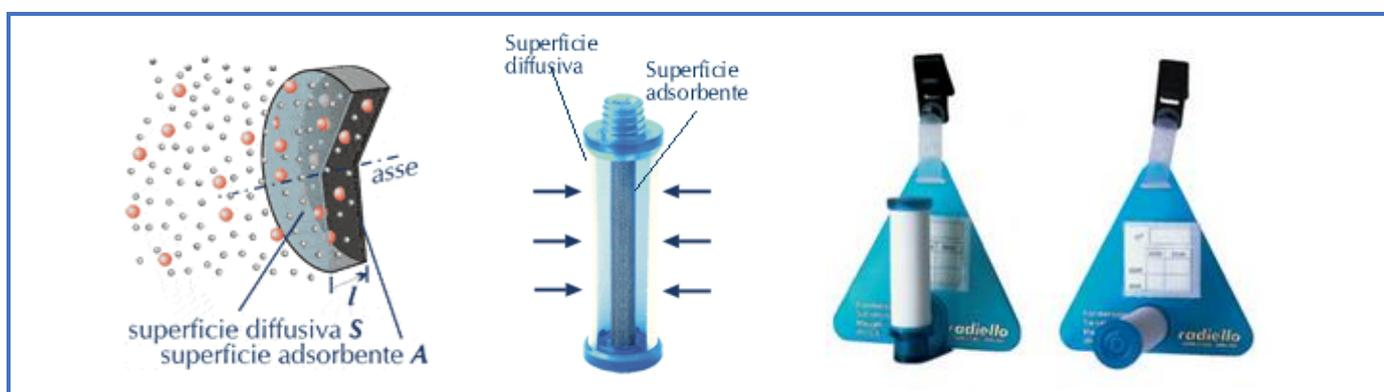
Figura 6 - Schema di funzionamento di un campionatore passivo
