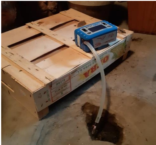
Campionamento con fiala in foro sul pavimento della cantina
