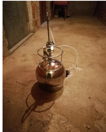
Campionamento con fiala in tombino sul pavimento della cantina
