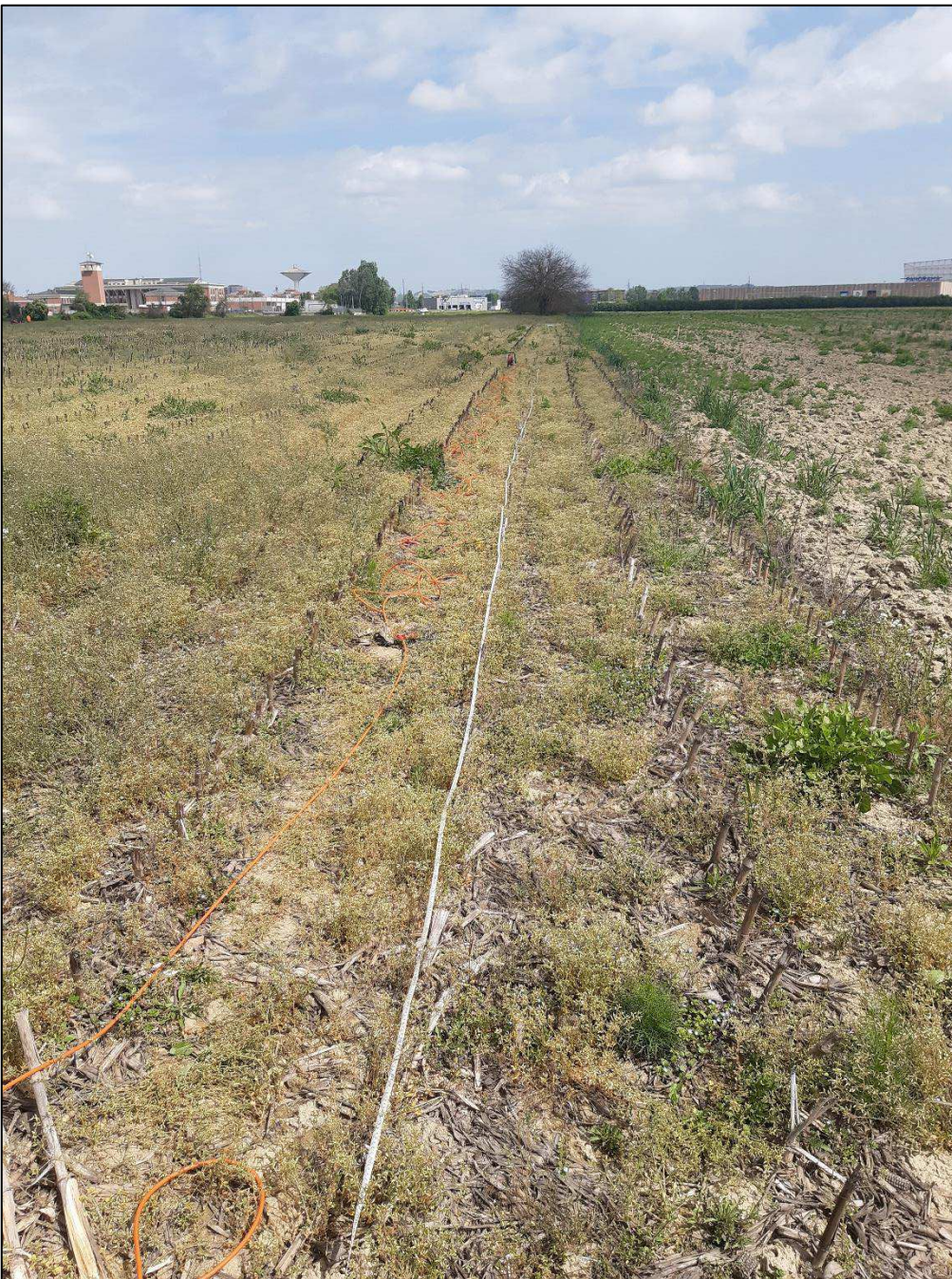
Stendimento prova sismica MASW 1
