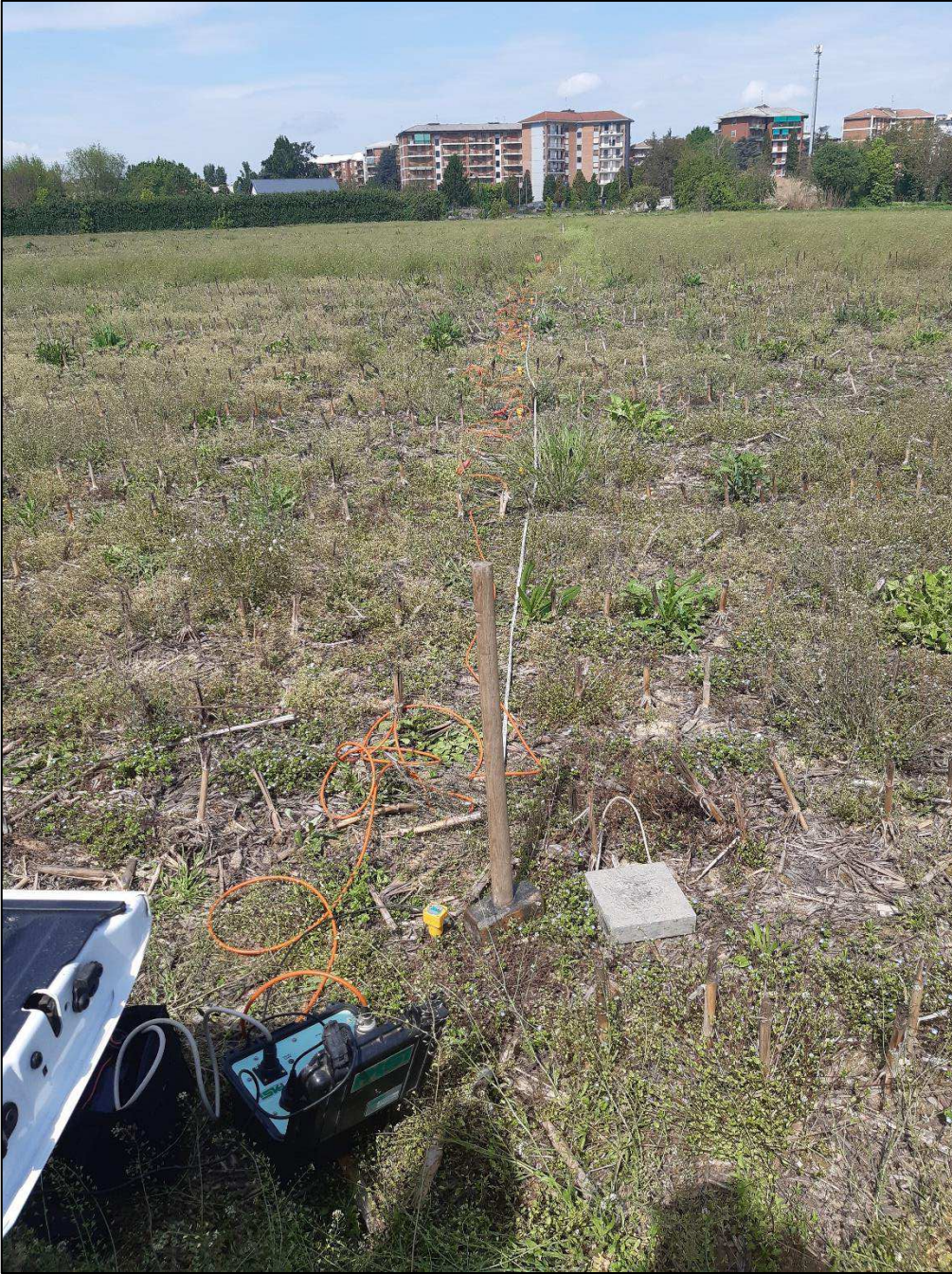
Stendimento prova sismica MASW 2
