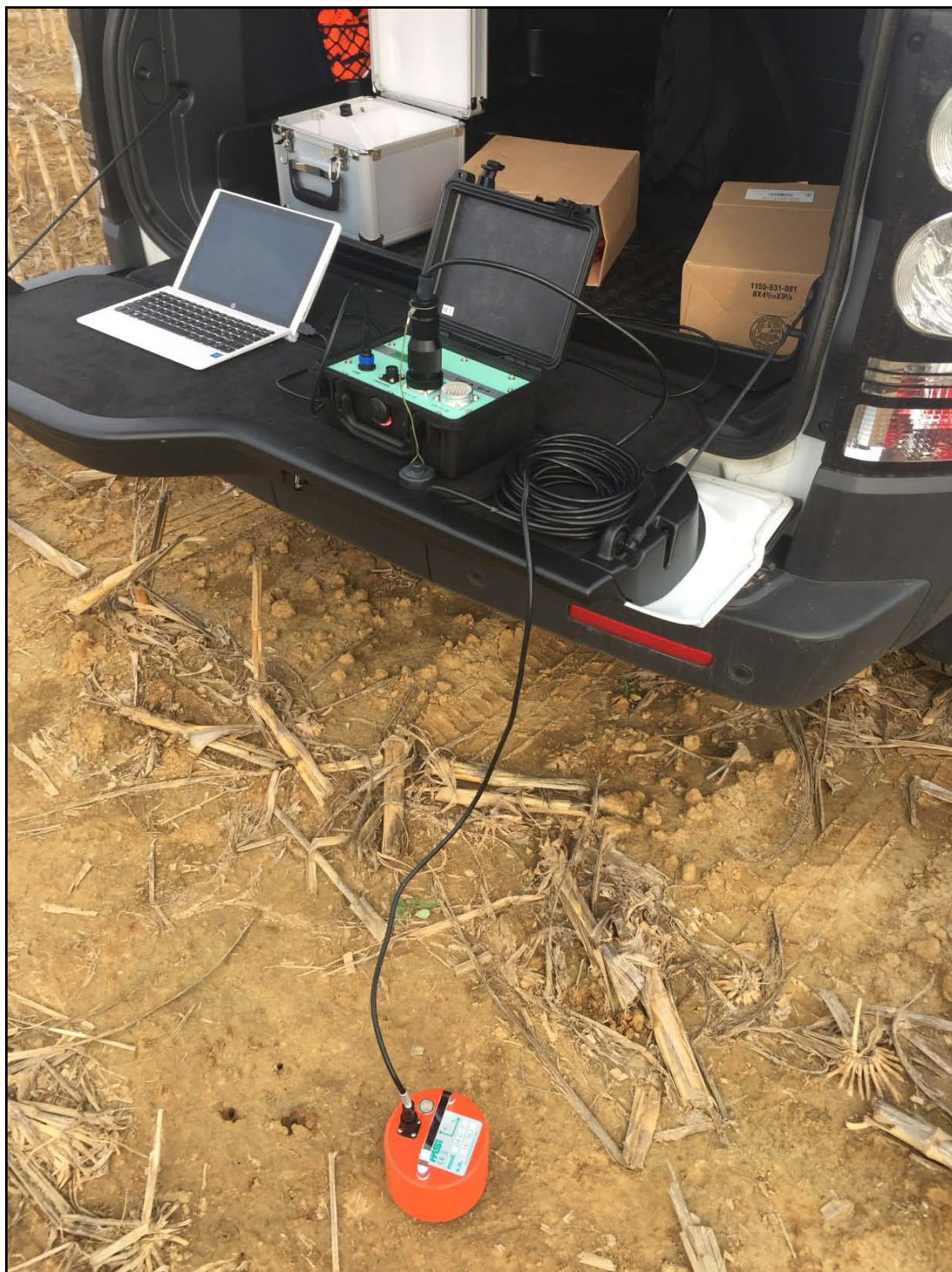
Geofono triassiale per indagine sismica passiva HVSR
