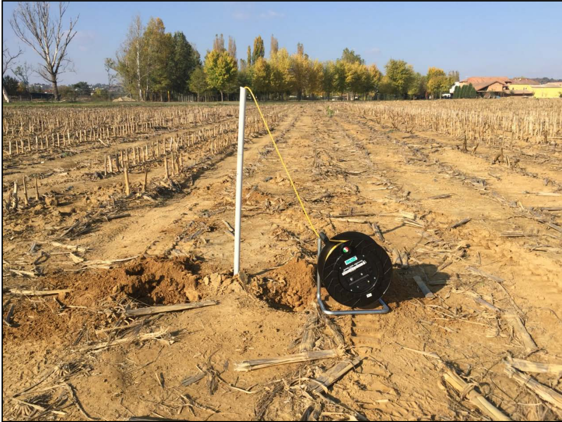
Tubo piezometrico per misura della falda
