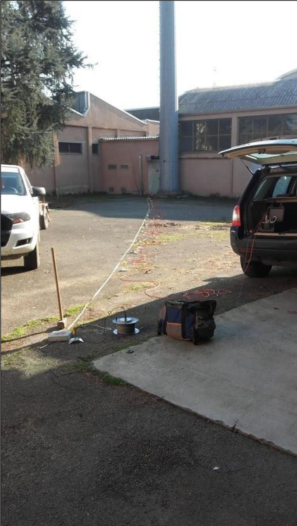
Stendimento sismico PROVA MASW (piazzale fabbricato esistente, 2018)
