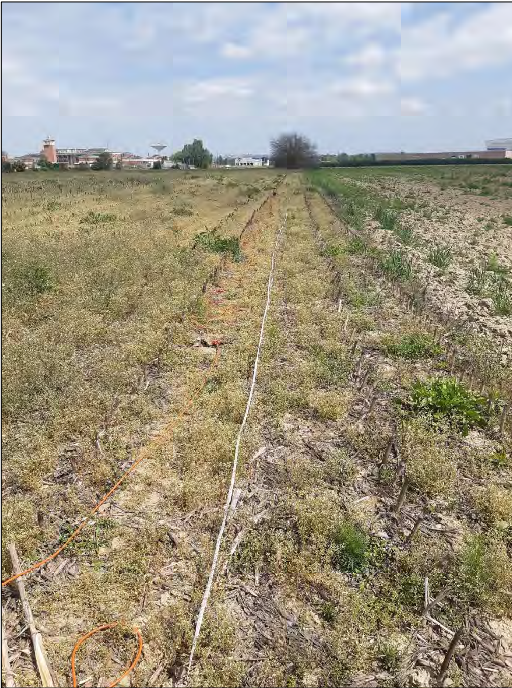
Stendimento prova sismica MASW 1
