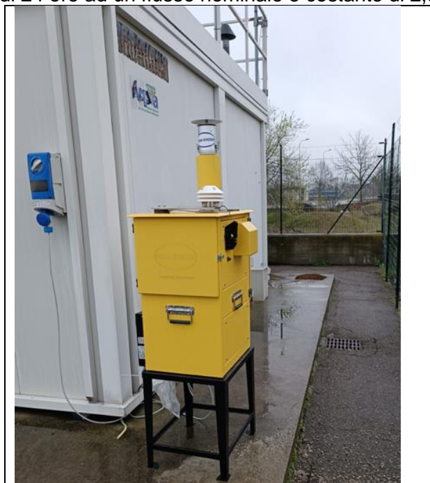
Figura 3-Campionamento di polveri PM10 su filtro di quarzo
