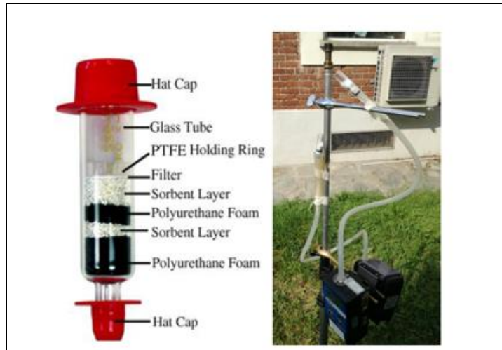
Figura 2-Fiala adsorbente: filtro in fibra di quarzo-XAD2
