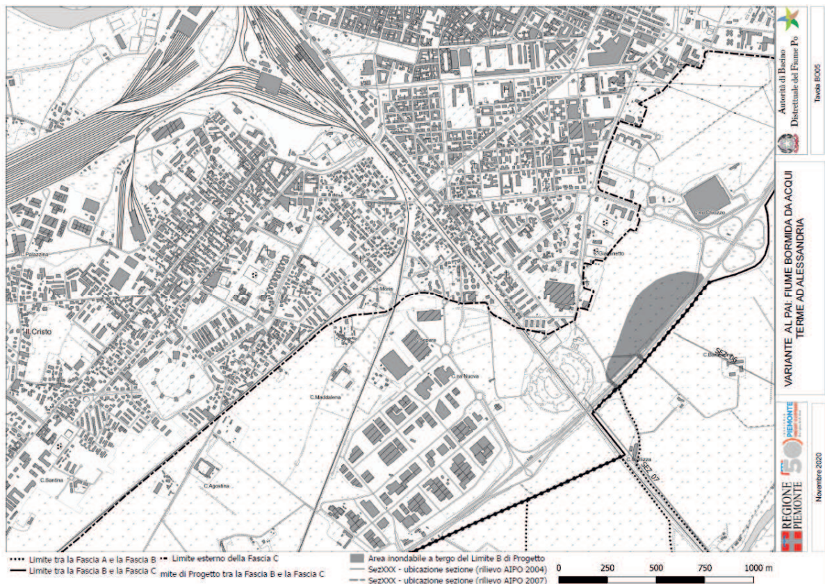
Figura 1: Tavola BO05 dell'Atlante cartografico Fasce Fluviali VARIANTE AL PAI - FIUME BORMIDA da Acqui Terme ad Alessandria (Novembre 2020)
