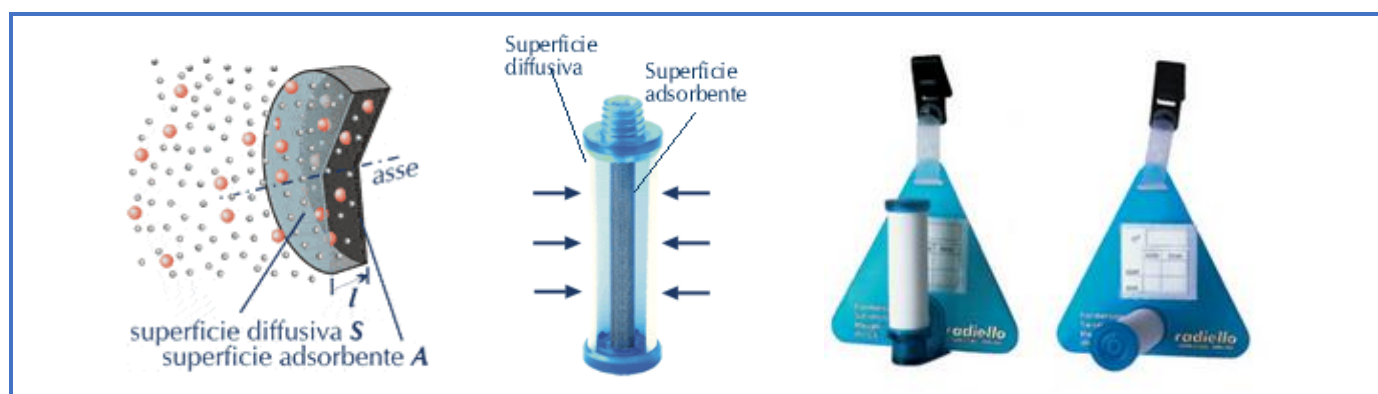
Figura 7 - Schema di funzionamento di un campionatore passivo
