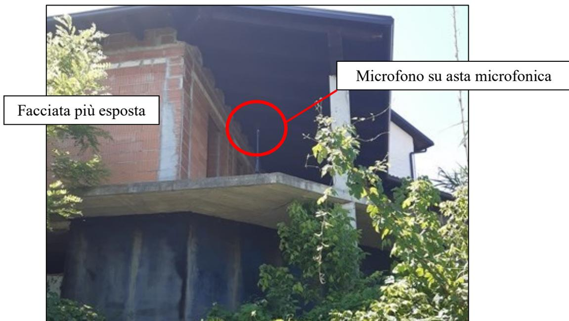
**Fig. 8 – Fonometro in misura**
