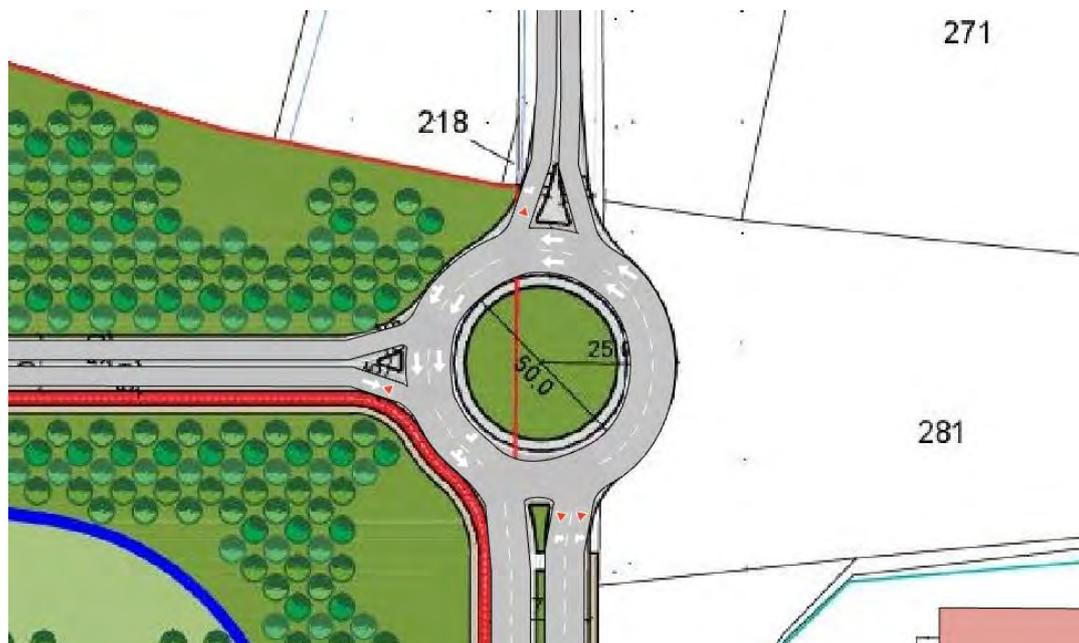
Figura 107 – Schema della rotatoria di accesso all'immobile 2
