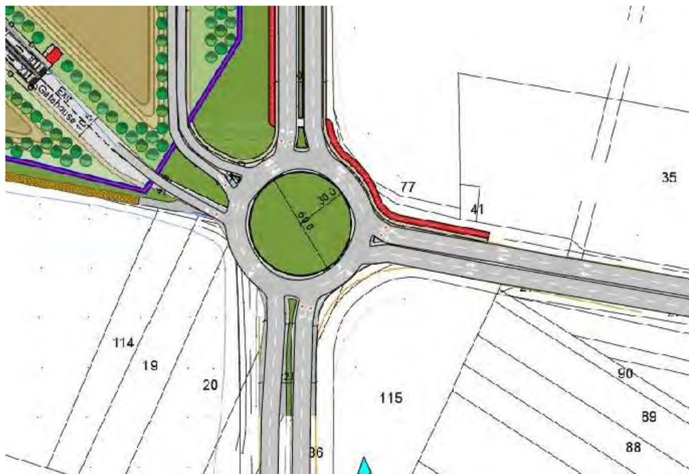
Figura 109 – Schema della rotatoria di accesso all’immobile 1, lato Sud
