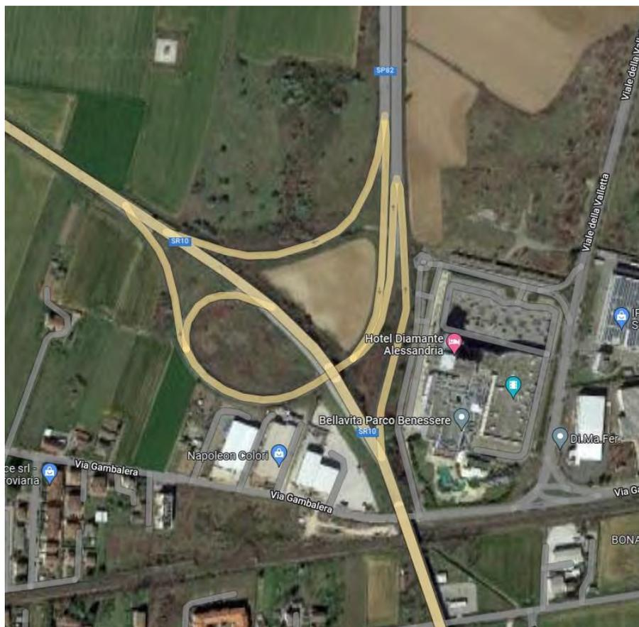
Figura 8 – Intersezione a livelli sfalsati SS10/SP82
