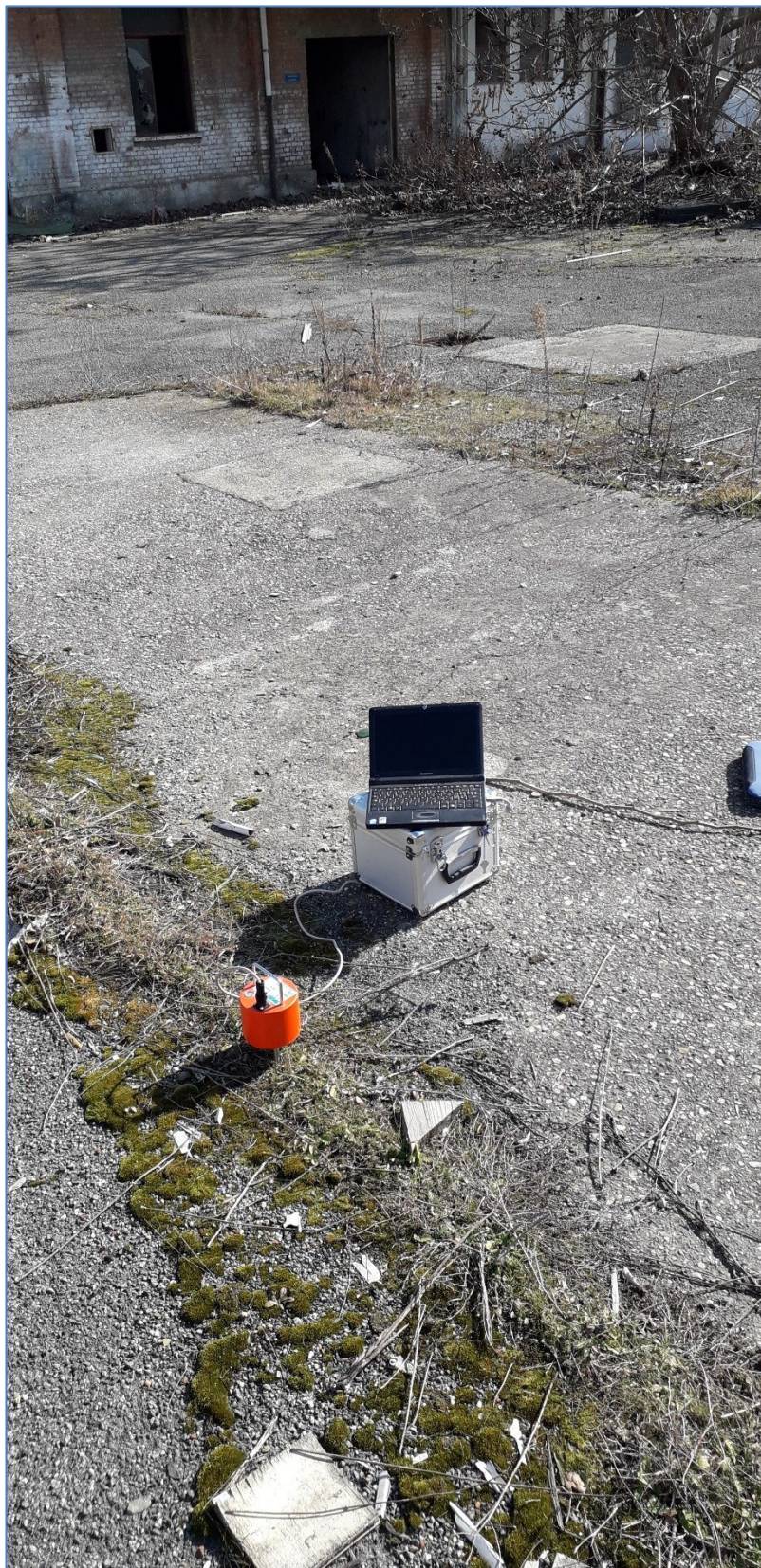
PROVA SISMICA HVS STRUMENTAZIONE PASI - MOD GEMINI 4.
