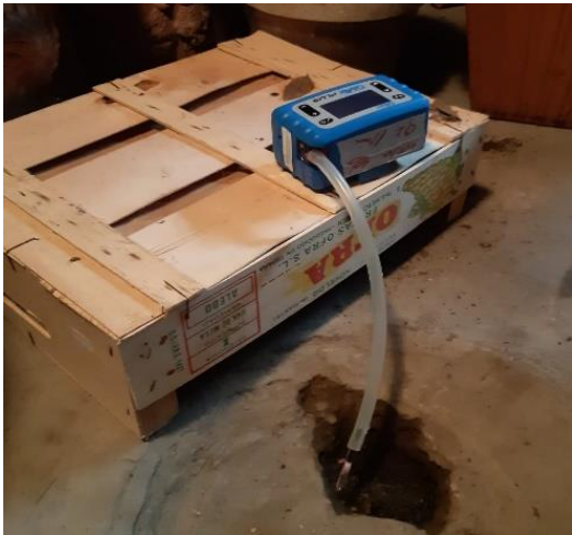
Campionamento con fiala in foro sul pavimento della cantina
