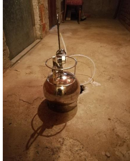
Campionamento con canister in foro sul pavimento della cantina
