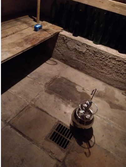
Campionamento con fiala e canister con tombino su pavimento della cantina
