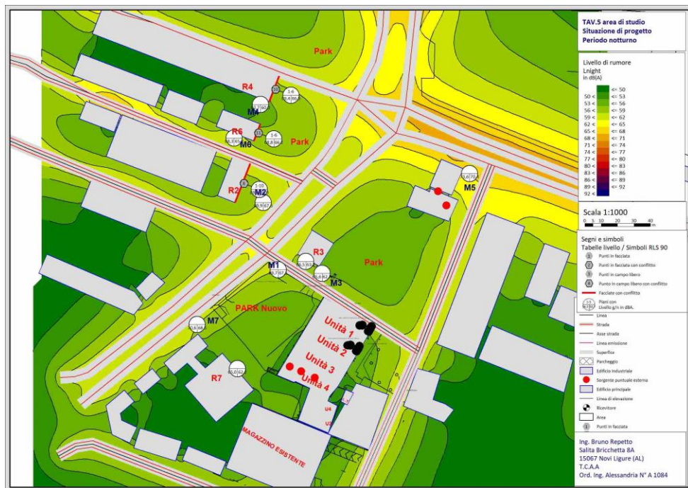
Figura 27: Situazione post operam - Livelli rumorosità notturni
