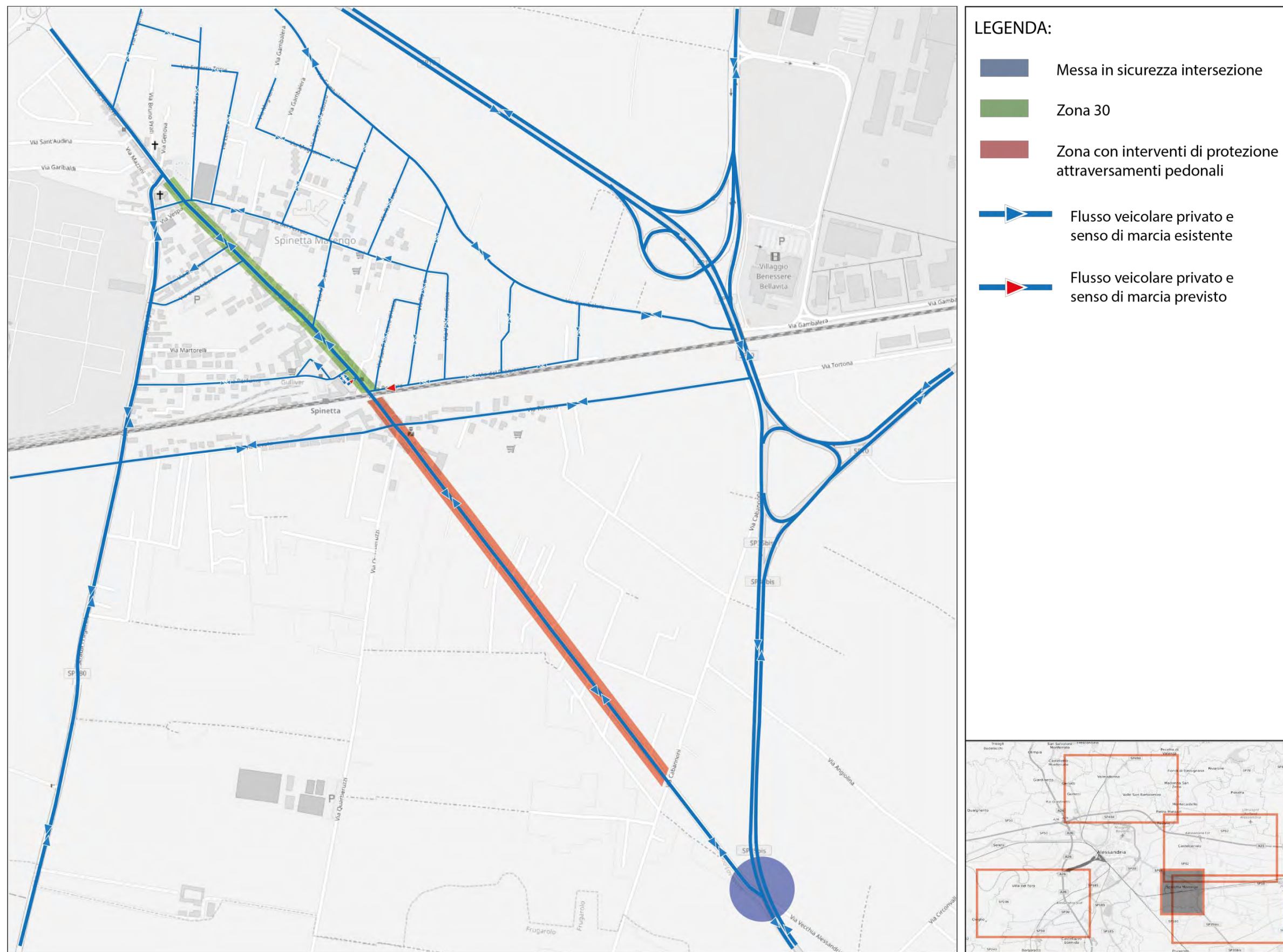
Figura 6-9: Interventi di moderazione del traffico a Spinetta Marengo
