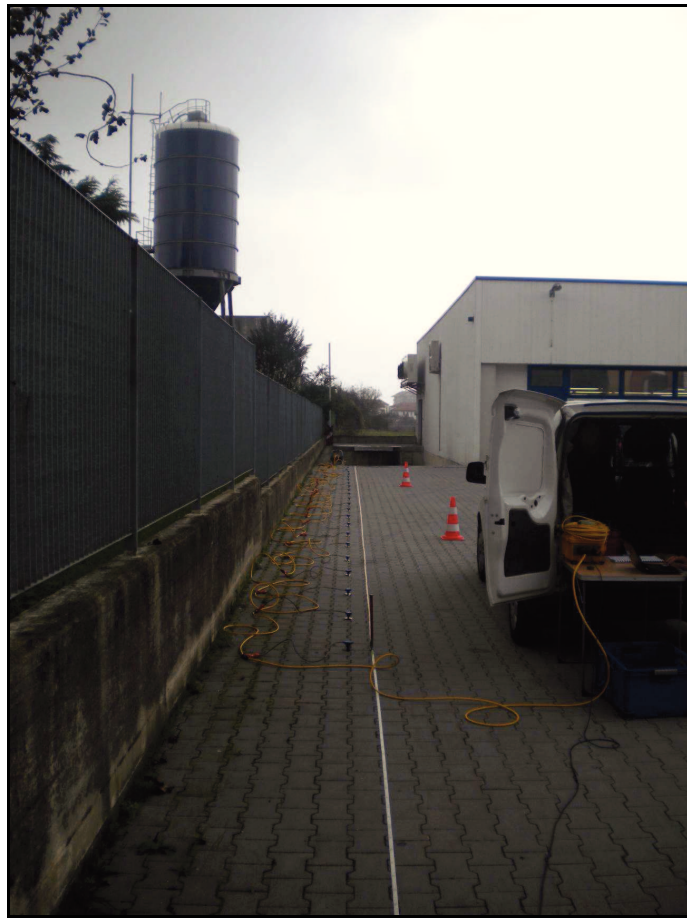
Figura 3: Vista dello stendimento MASW.
