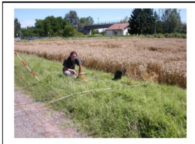
Foto 5: Esecuzione prova geofisica di tipo MASW.
