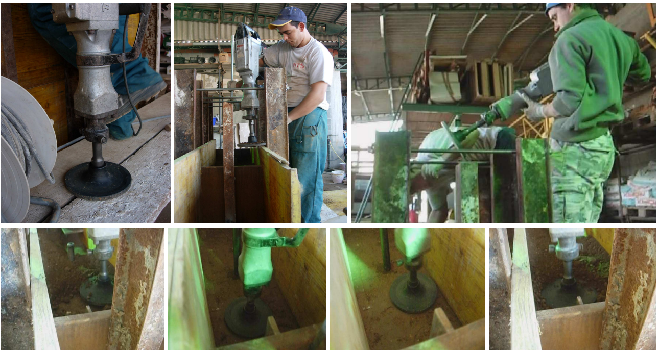
Sequenza di battitura realizzata con uno strumento pneumatico.
