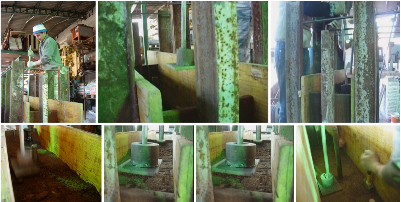
Battitura realizzata con uno strumento tradizionale riprodotto dall'impresa Boschetto S.r.l.
